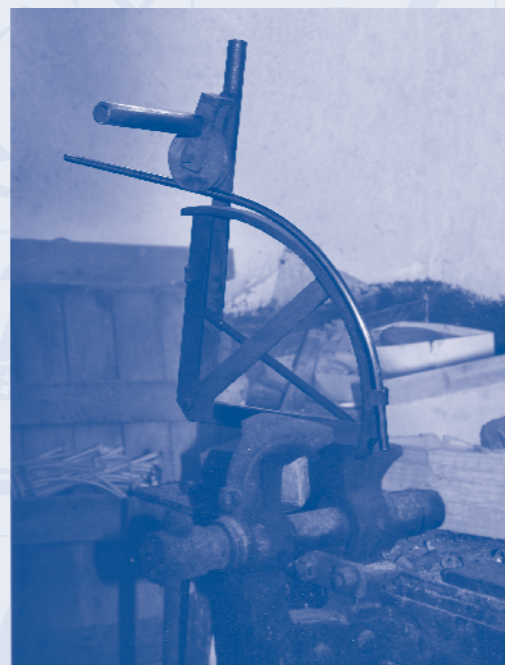
Eine der ersten selbstgefertigten Biegevorrichtungen für Shopper® Gestelle 1959
